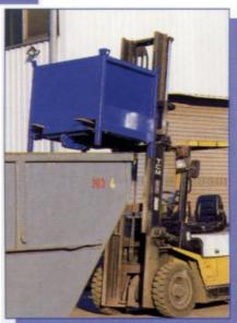
Vom Aufnehmen des Behälters über die Entleerung bis zum Absetzen ist das Absteigen vom Stapler nicht notwendig.
